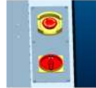
Start düğmesine basın ve ilk 6 saat mikrobiyal bakterilerin etkinleşmesini bekleyin. 6 saat sonunda gıda atıklarını makineye atabilirsiniz.
